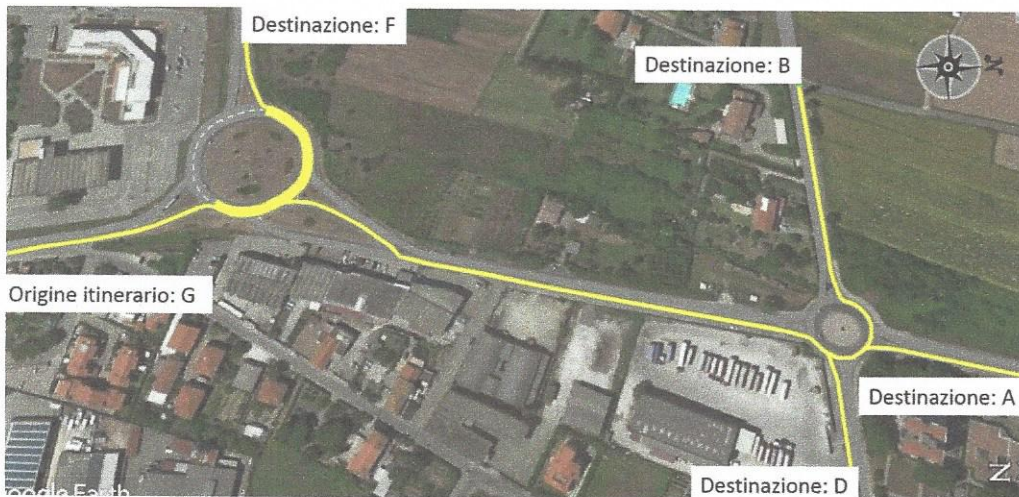
Figura 4 Esempio di creazione degli itinerari di percorso su Vissim
